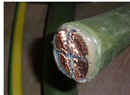
Section d'un câble d'alimentation de l'armoire électrique
